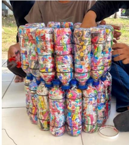
**Gambar 4.** Proses penyatuan *ecobrick* menggunakan kawat
